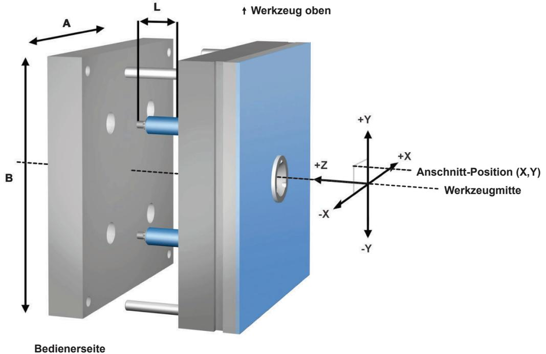
Die Düsen werden von der Maschinendüsenseite her gesehen nummeriert und die Düsenposition wird gleichermaßen mit den X,Y-Koordinaten bestimmt.
